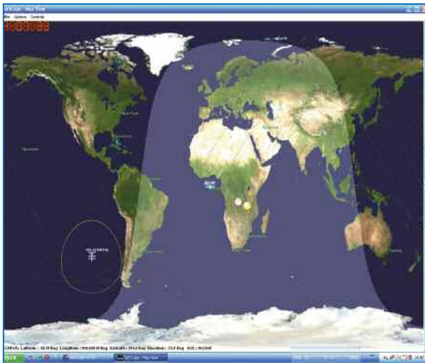
Где в данный момент на орбите находится МКС и какие участки Земли в её зоне радиовидимости, отображает программа SatScape.
