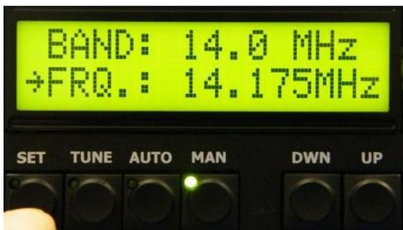
Для входа в режим ручной настройки следует нажать клавишу MAN. Нажатием клавиши MAN выбирается диапазон и сегмент диапазона. Управление сегментом или диапазоном производится перелистыванием клавиш UP/DWN.
