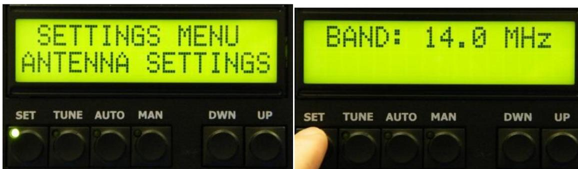
Затем следует выбрать количество антенн, которые будут использоваться на данном диапазоне (1 или 2); выбор всегда следует подтверждать нажатием клавиши SET. Перелистывая список клавишами UP/DWN, следует назначить порт PORT внешнего антенного переключателя для данных антенн (ANT1 на PORT 01).
