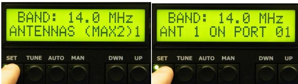
Если принято решение использовать 2 антенны на данном диапазоне, после подтверждения одной антенны следует продолжить конфигурирование второй антенны и ее порта. Для того, чтобы закончить конфигурирование антенн, следует нажать клавишу AUTO, либо MAN.
