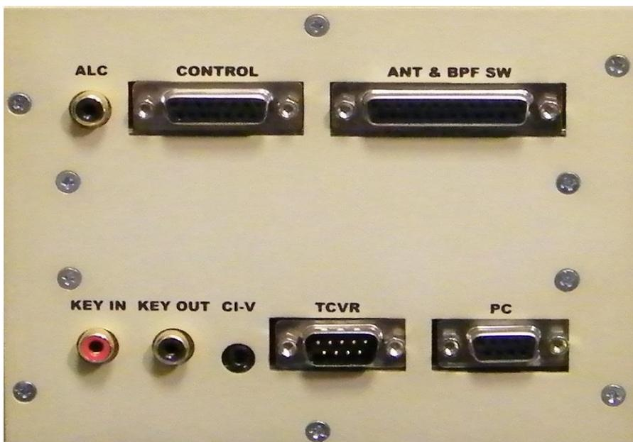
**KEY IN** - входной сигнал РТТ (напряжение/ток переключения 5 В/2 мА).
