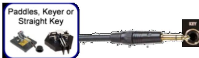
Если вы используете CW ключ типа весла или манипулятора, подключите TRS-разъём в следующем соответствии: DOT - это кольцо контакта, DASH – это втулка. Для обычного ключа, используя TS-разъем, кольцо можно не использовать.
